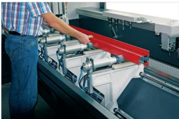
Maschinenbett, das als modernes Schrägbett ausgeführt ist
